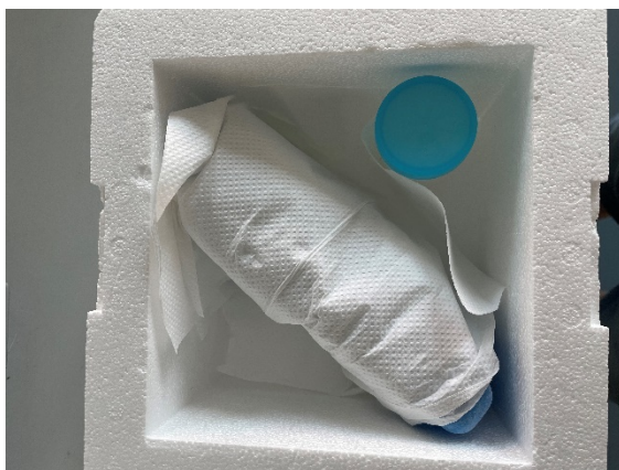
Abb. 2: Kühlakkus mit dem Probenbehältnis in einer isolierenden Box. Die Kühlakkus sollten keinen direkten Kontakt zur Probe haben (einfrieren vermeiden). Eine kurze Transportzeit ist essentiell für die Probenqualität.
